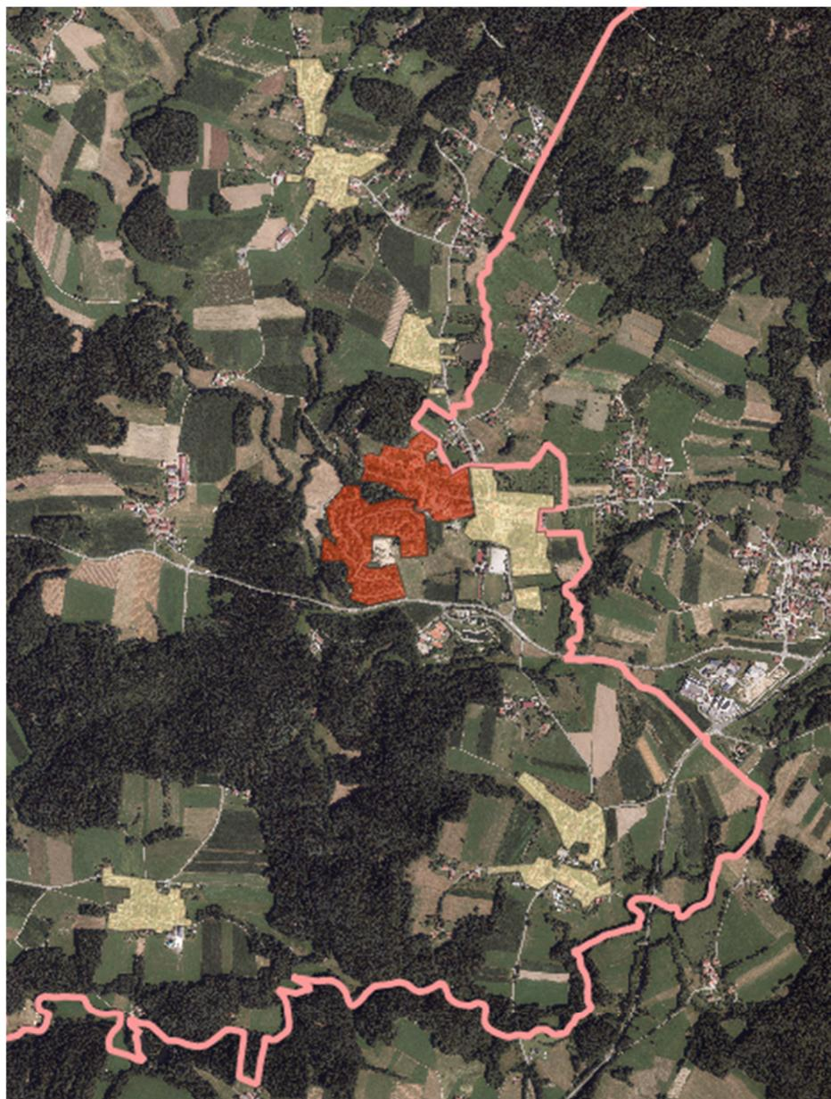
Wärmebedarfsdichte baublockbezogen (in MWh/ha\*a)
